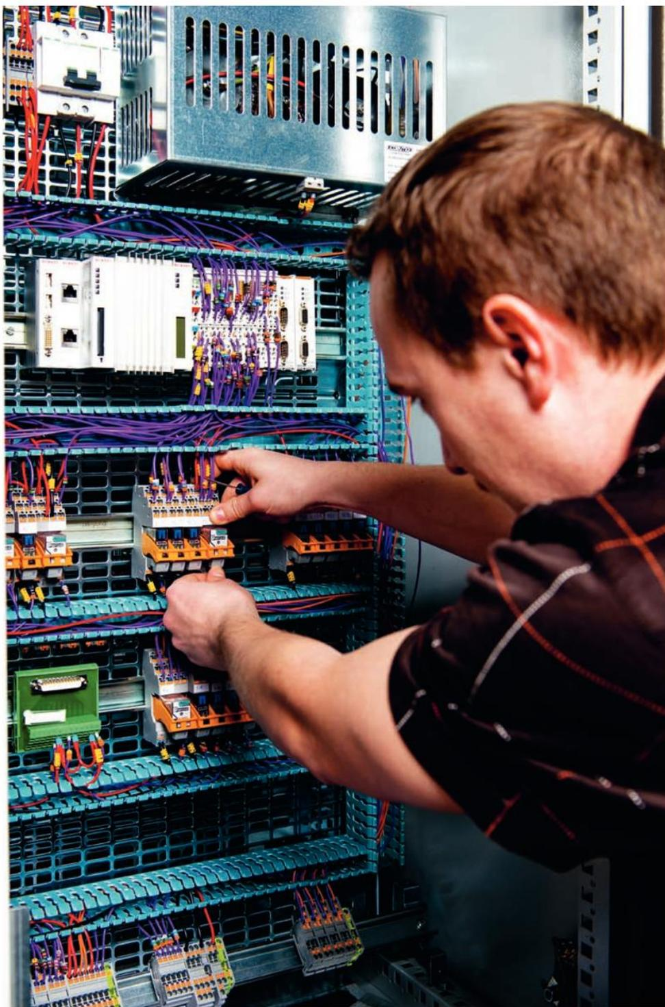
**fig.** Câblage d'une baie électronique utilisée pour le contrôle du vide de Virgo. Les détecteurs d'ondes gravitationnelles utilisent les plus grandes enceintes à ultravide du monde.
