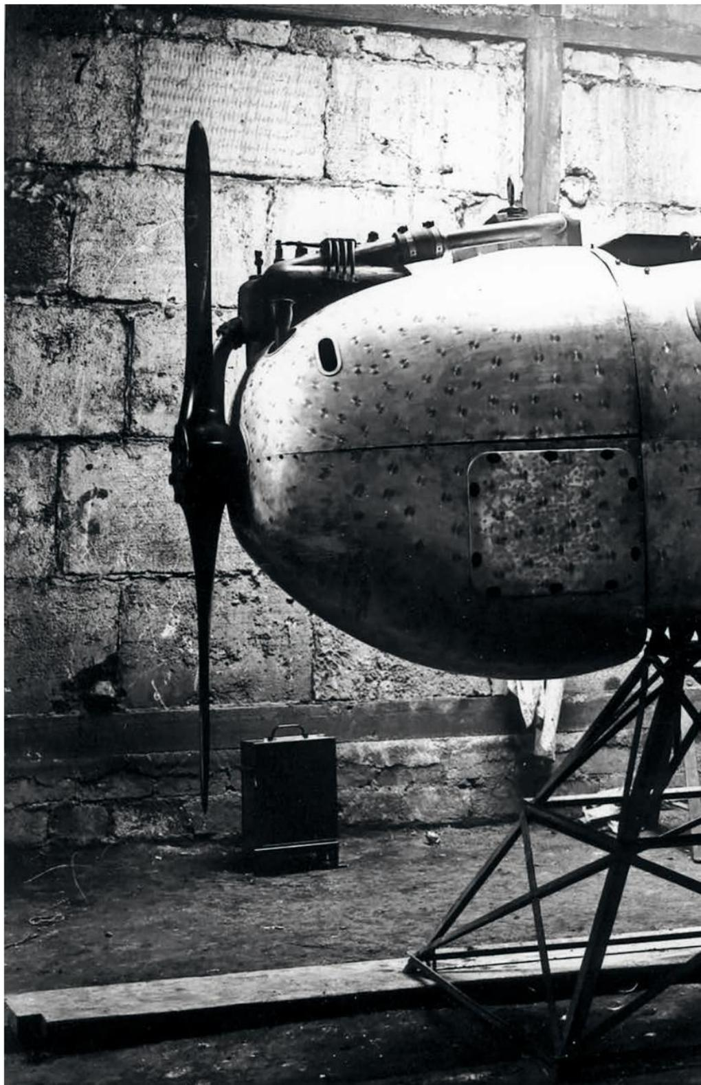
Le *Piloteur Lender* est destiné à former au sol les élèves pilotes. Cet engin, dont les premiers essais ont lieu en 1920, doit surtout permettre de leur donner les réflexes qu'exige le maniement d'un avion. À l'époque, l'armée en attend beaucoup : elle ne dispose pas des appareils nécessaires à la formation de tous ses élèves et
