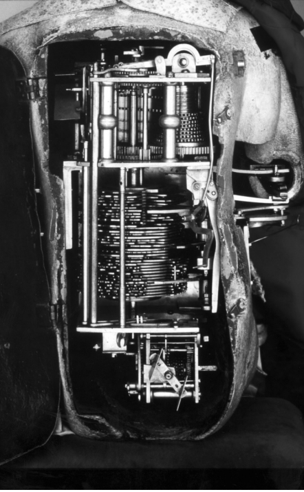
Fig. 2.9 Mécanisme du Dessinateur (Musée d'art et d'histoire, Neuchâtel, Suisse).
