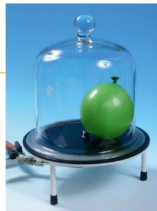
Doc. 4 Expérience 2 : effet d'une diminution de la pression extérieure
