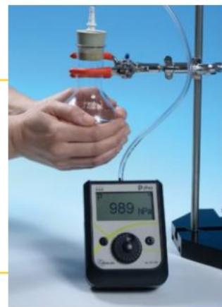
Doc. 3 Expérience 1 : effet de la température sur la pression
