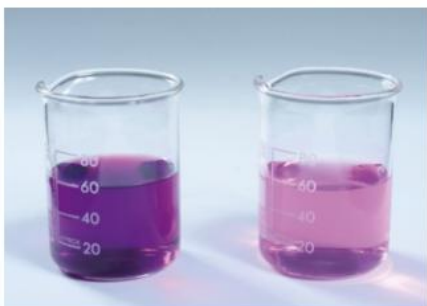
Doc. 7. La solution de permanganate de potassium laisse passer les radiations rouges et bleues.
