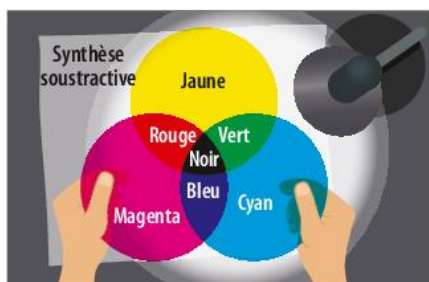
Doc. 7. Superposition de filtres cyan, magenta et jaune sur de la lumière blanche.
