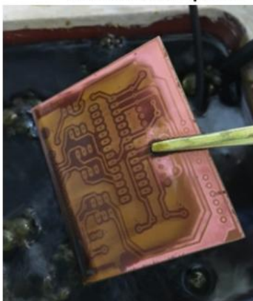
Doc. 1 Fabrication d'un circuit imprimé
